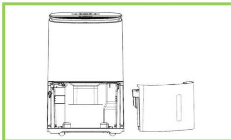
**Schritt 2:** Nehmen Sie den Wassertank aus dem Luftentfeuchter, heben Sie den Wassertankgriff an und entfernen Sie den Wassertankdeckel.
