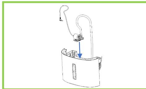
**Schritt 3:** Befestigen Sie die Pumpe mit den beiliegenden Saugnäpfen im Wassertank direkt unter dem Griff.
