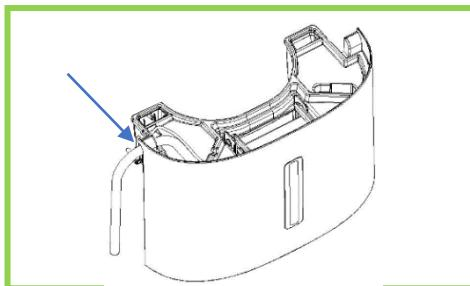
**Schritt 4:** Setzen Sie den Deckel auf den Wassertank, und führen Sie den Schlauch und das Kabel durch den Spalt auf der linken Seite aus dem Wassertank.
