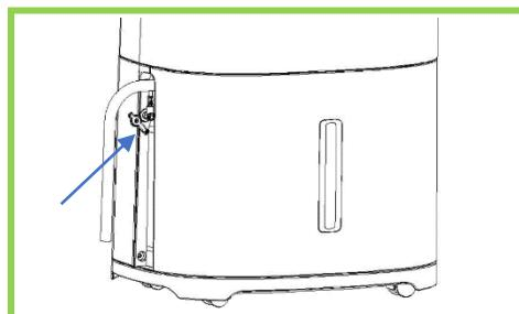
**Schritt 5:** Schieben Sie den Wassertank zurück in den Luftentfeuchter und entfernen Sie die kleine Gummiauflage in der linken Seitenaußensparung. Stecken Sie das Kabel in die Buchse ein.
