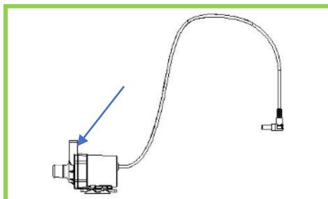
**Schritt 1:** Schließen Sie den Schlauch an den vertikalen Auslass an die Pumpe an.
