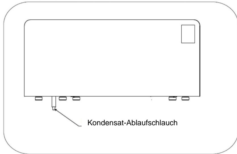
Wenn Sie den Abfluss auf die andere Seite verlegen möchten, können Sie dies durch Entfernen der Seitenabdeckungen tun - **dies sollte nur von einem qualifizierten Elektriker durchgeführt werden und nur dann, wenn die Stromversorgung des Geräts ausgeschaltet und isoliert wurde.**
